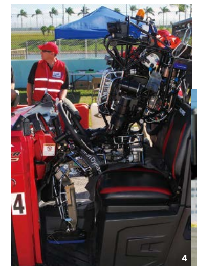
1,2 로보스메인팀 JPL과 팀 HKU의 로봇들. 3 일곱 번째 과제는 가스 밸브를 직접 잠그는 것이다. 4,7 인간의 도움 없이 다목적 차량을 운전해 현장까지 이동해야 한다. 5 팀 카이론의 엔지니어. 6 나사 존슨 스페이스 센터팀 발키리.
